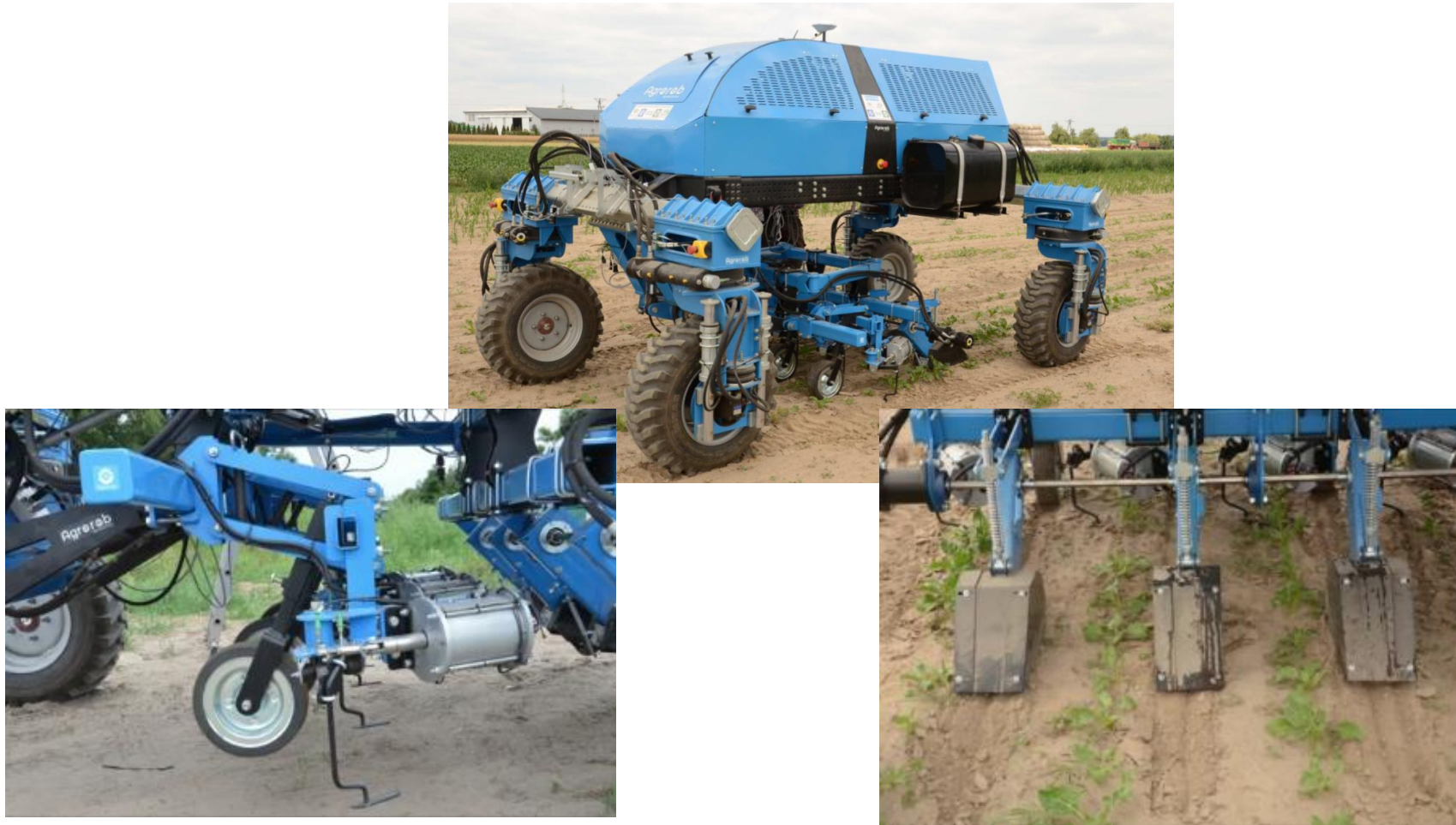
Agrorob z aktywnym pielnikiem do pracy w rzędach oraz aktywnym pielnikiem do międzyrzędzi (glebogryzarki)
