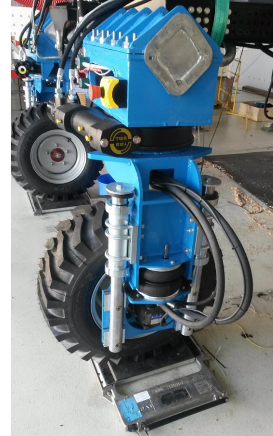
Pomiar siły nacisku kół jezdnych platformy na podłoże
