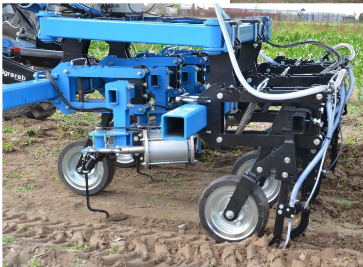
Z aktywnym pielnikiem do pracy w rzędach oraz pielnikiem do międzyrzędzi z dogłębową aplikacją nawozów
